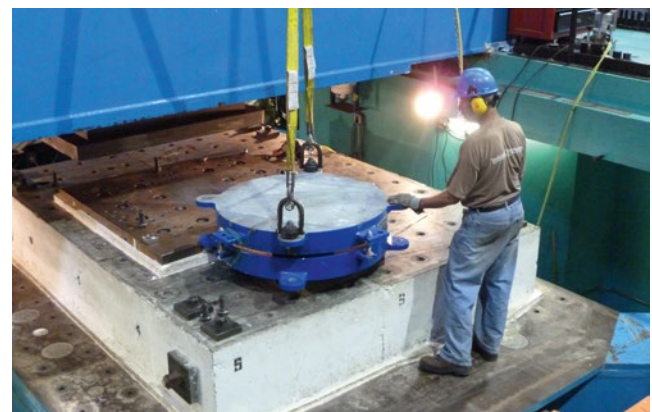
Einrichten des Lagertests in San Diego, wo maximal vorstellbare Erdbeben simuliert werden können.
