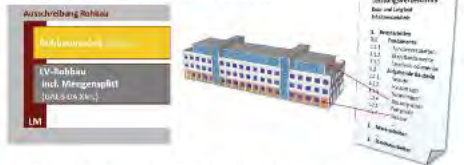
LM = Link-Modell, stellt die Beziehungen her zwischen den einzelnen Fachmodellen (FM) wie z.B. 3D-Rohbaumodell und Leistungsverzeichnis
