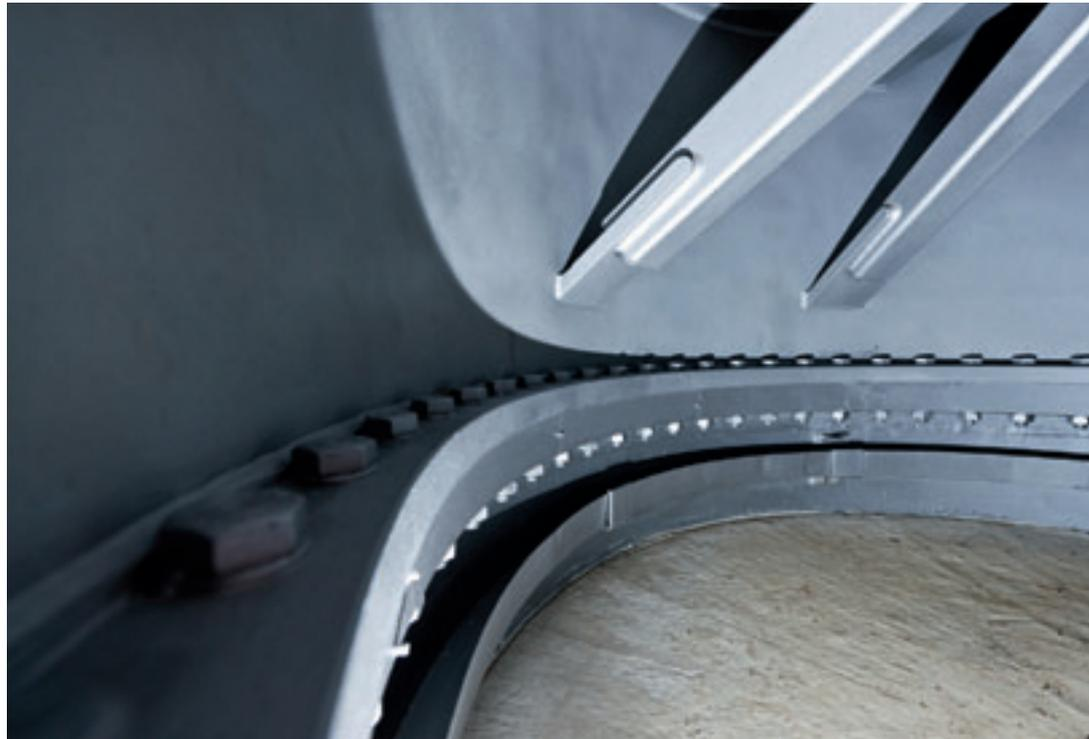
▲ Detailansicht Exenterrückenlager in Achse 3 an der Antriebsseite mit Wellen einschl. Lamellenkupplung, Buchsen, Exenterrollen an der Oberseite.
