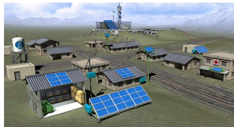
Abb. 3.2.1.3.1: Beispiel einer Minigrid-Anlage mit dezentraler PV-Stromerzeugung, Windkraftanlagen, Batterien, einem Dieselgenerator und einem kleinen Verteilungsnetz. Zusätzlich ist hier ein großer Wasserspeicher zu sehen. Die Pumpe für den Wasserspeicher dient als Beispiel für eine zeitlich verlagerbare Last, die Teil eines integrierten Steuersystems sein kann, das auch das Nachfragemanagement (Demand-Side-Management) umfasst. | Quelle: http://www.ennera.com/en/detail-solution/minigrids
