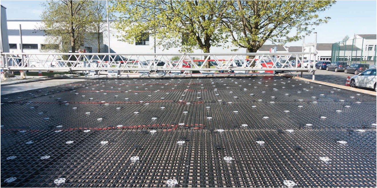
Smart-Deck-Demonstrator: Test aller Funktionen unter Praxisbedingung auf einer Fläche von circa 80 m 2
